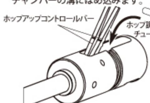
⑦15mmのOリングをバレル側から入れ溝にはめてホップアップコントロールバーを押さえます。
